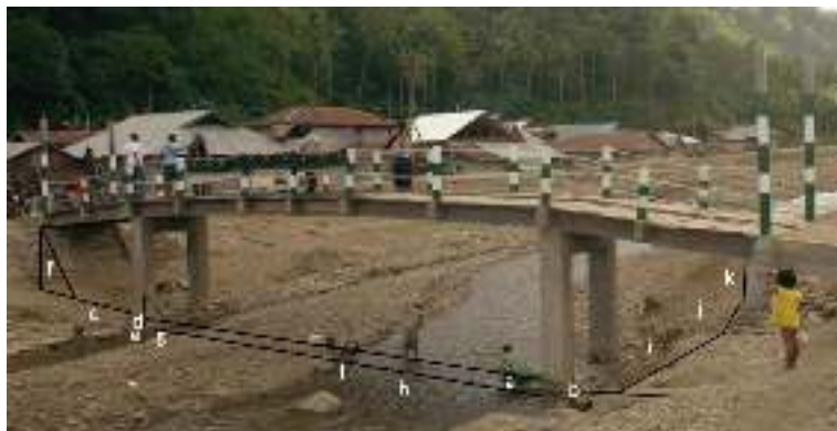
Gambar 27. Contoh jarak pixel yang diukur untuk mendekati sketsa tampang sungai
