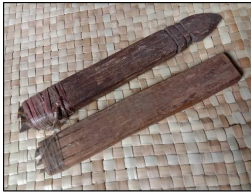
Rajah 6: Alatan dikenali sebagai ‘jangka’ yang digunakan untuk membelah daun Mengkuang mengikut saiz yang telah ditetapkan
