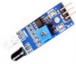
Rajah 3. Modul Sensor Inframerah
